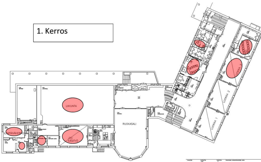
Kuva 7. 1. kerroksen tilat, jotka tarkastettiin pintakosteudentunnistimella ja aistinvaraisesti.
