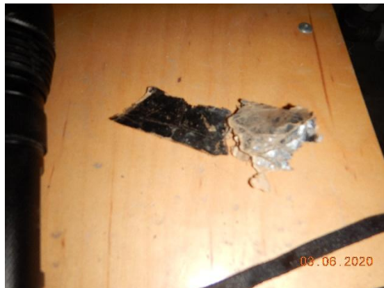
Mustasta pahvieristeestä otettu näyte ei sisältänyt asbestia.
